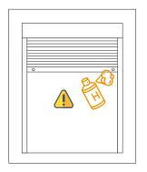
Suba la persiana completamente y luego pase una aspiradora por las guías laterales.
