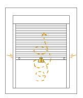
No deje la persiana parcialmente cerrada. Producto de vientos muy fuertes, se puede producir una corriente de aire que puede causar que las láminas se salgan de las guías laterales, dañando la persiana.
