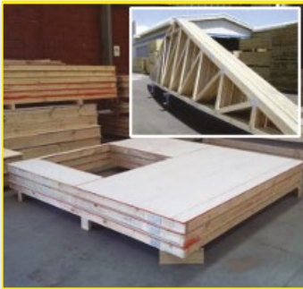
PANELES Y CERCHAS MADERA
